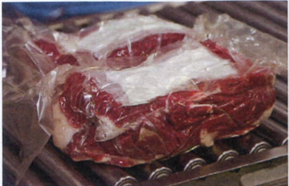
筋を引き、余分な脂を削った肉は、オゾン殺菌を経て真空パックされる。金属探知機にも通される。もし作業中にナイフが欠けた場合は作業をすぐ中断し、確認。
